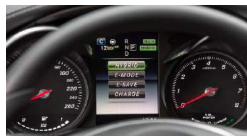
Modos de conducción híbrido, eléctrico, combustión y recarga
