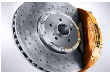
Discos AMG Carbon Ceramic 402 x 39 mm delante y discos de 360 x 32 mm detrás
